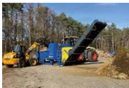
HFG V versione azionata via PTO con albero cardano
