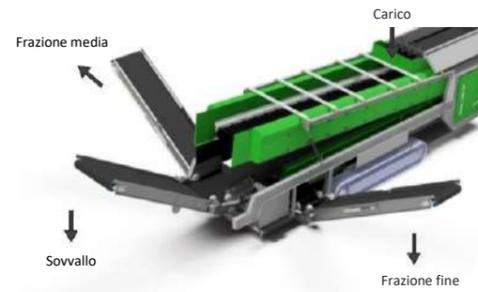
Con sistema esclusivo Vario per la regolazione della pezzatura
